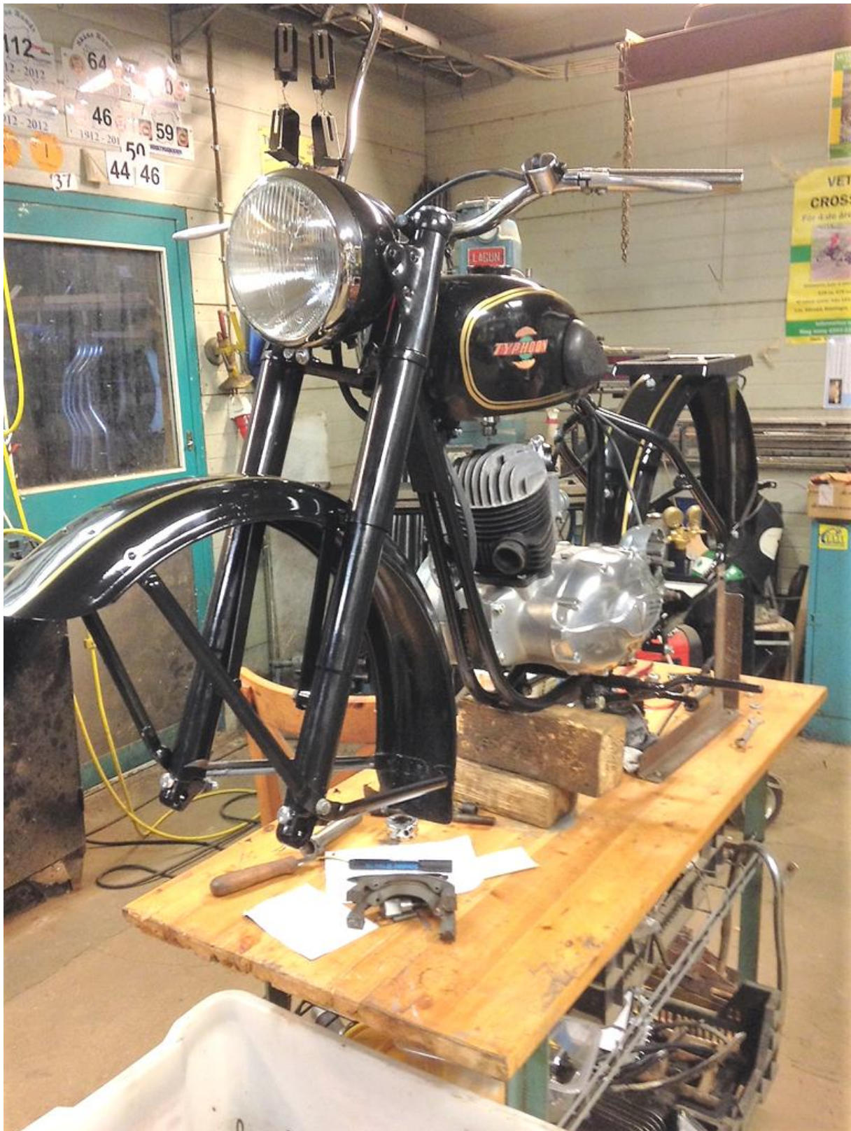
28/9 Hojen i stort sett färdig. Lite problem med hjulen pga 40-ekrat baknav och passande fälg.
