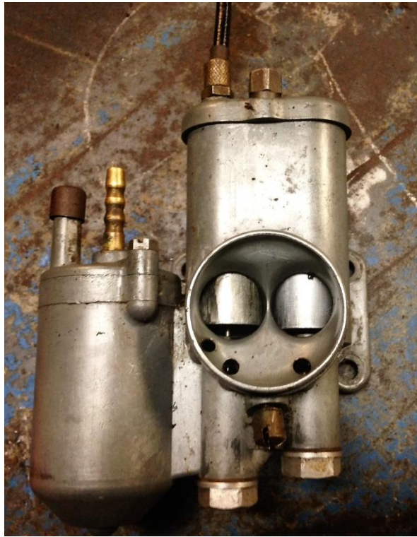
Dubbelförgasaren med 2 trottlar i luftintaget.
