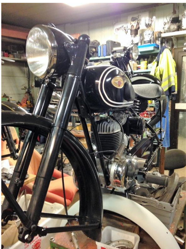
Framgaffel monterad efter inspektion och lackering
