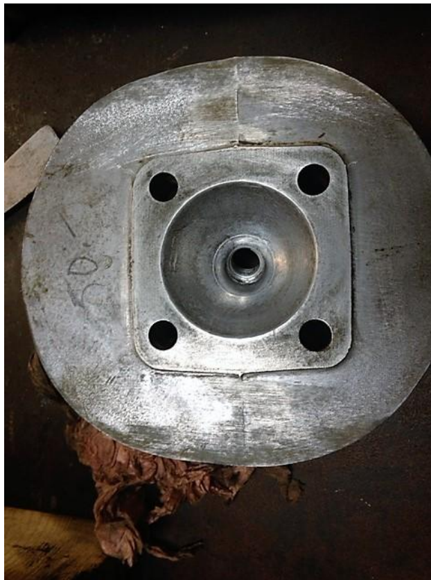
Topplöck efter rengöring och därefter en lätt blästring
