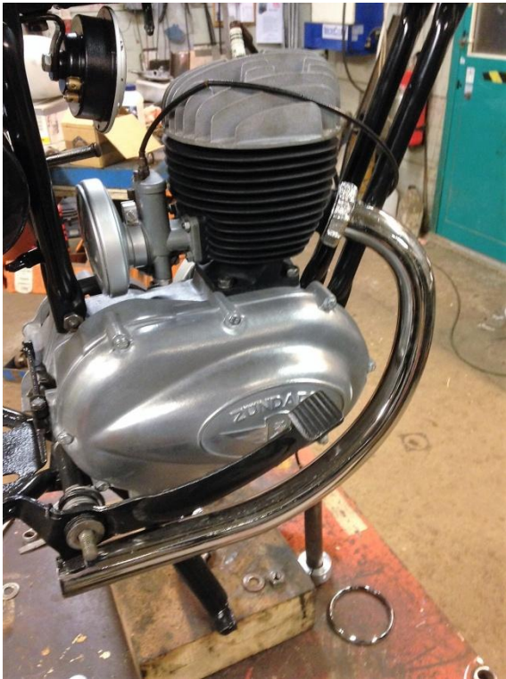
Motorn monterad i ram. Notera ramrören som går ned till motorns bakre fäste.
