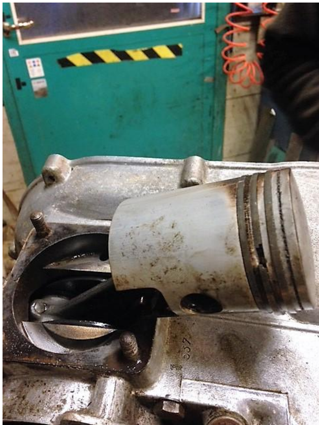
Kolv innan demontering och rengöring
