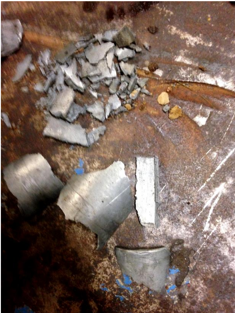
Till vänster Sprängd trottels. Ej att rekommendera vid demontering av trottlar.
