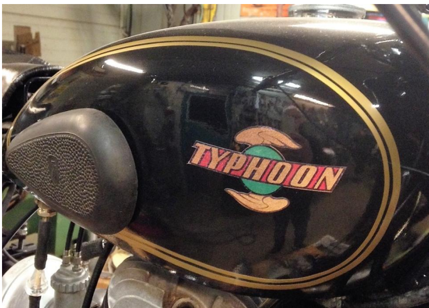
Nylackad bränsletank med logga, guldgula stripes och glycerolbehandlade knägummi.
