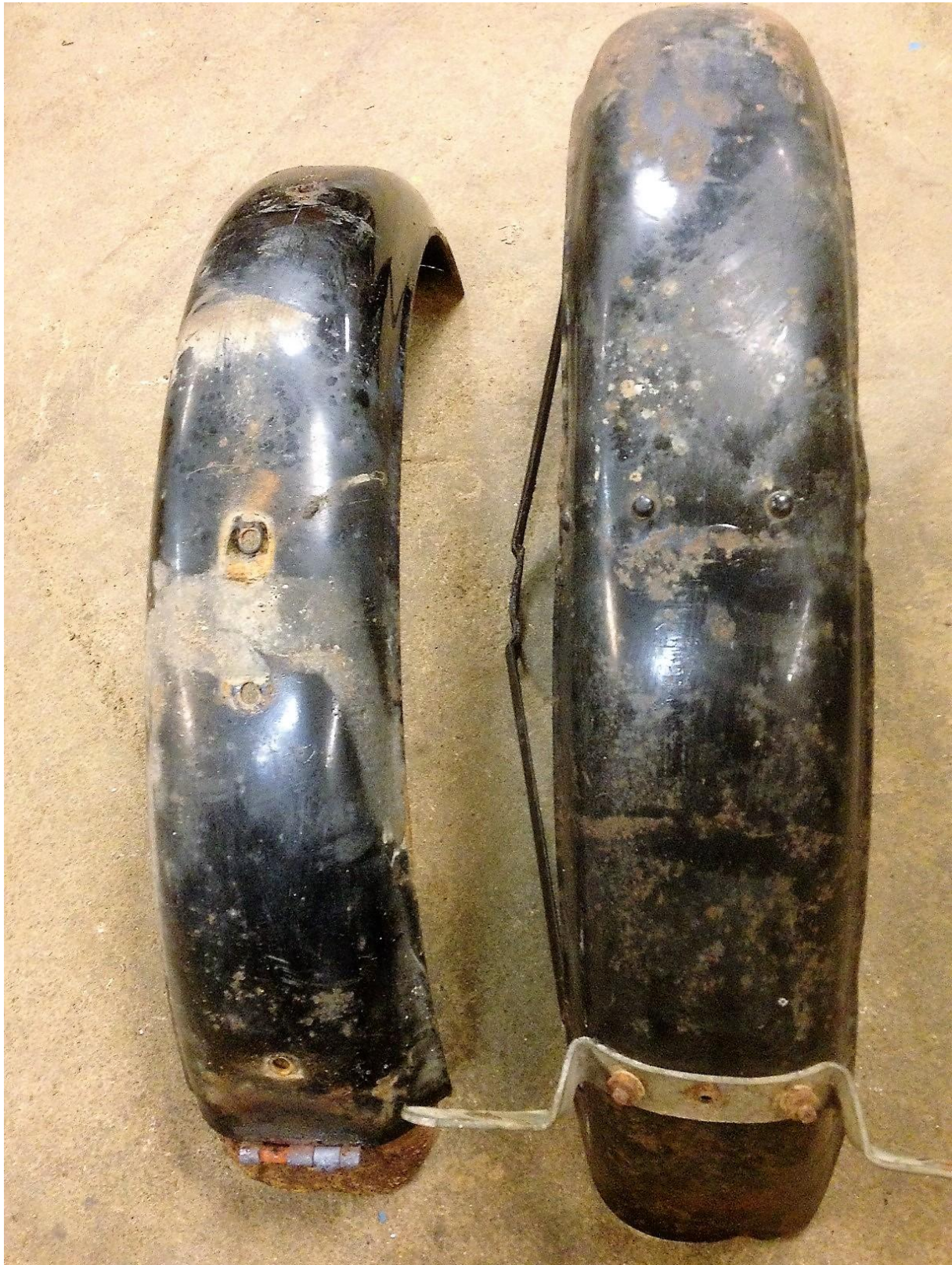
Bak och framskärm. Bakre skärmen kapad vid gångjärn.
