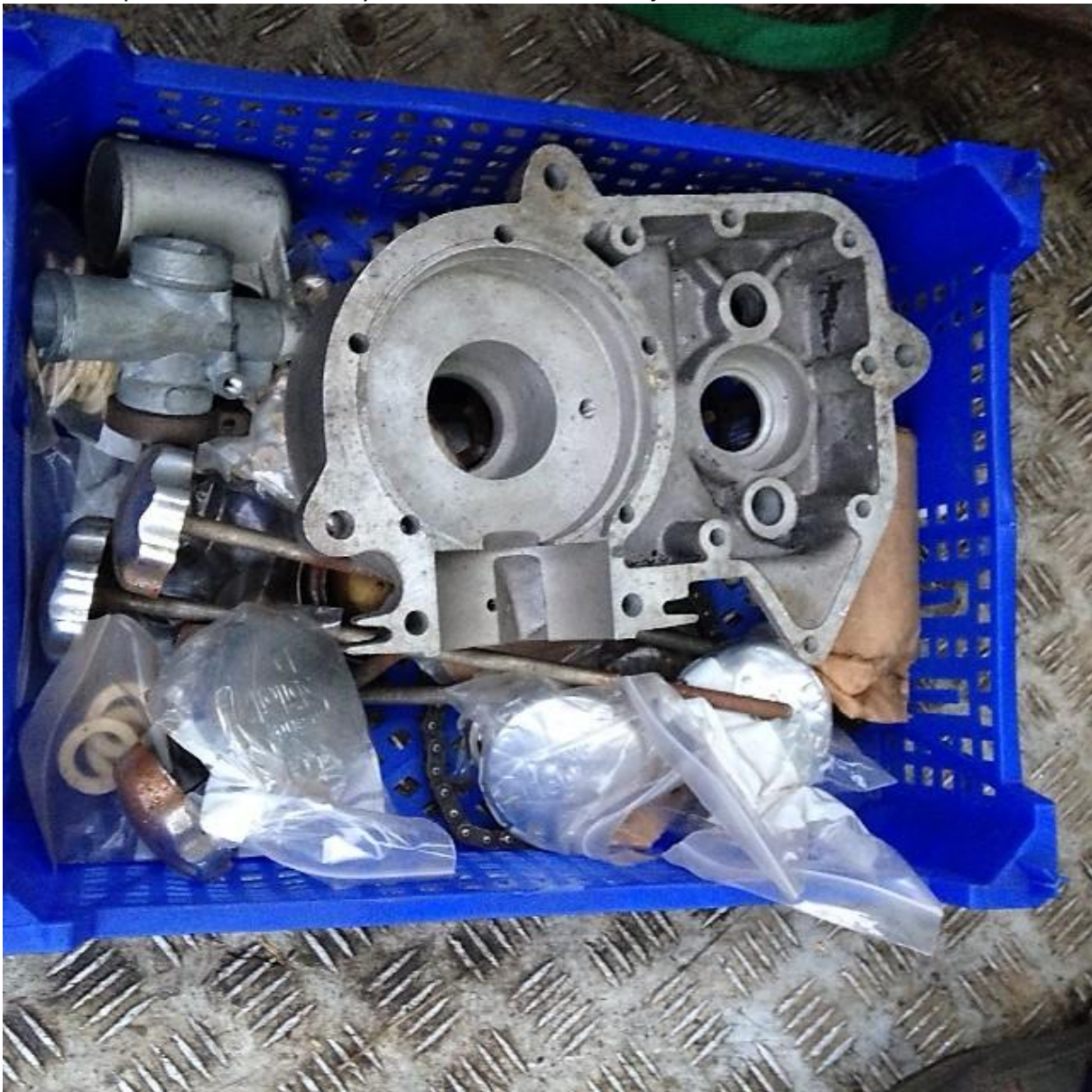
En låda med en ny förgasare och en vevhusalva plus också styrbromsdelar.
