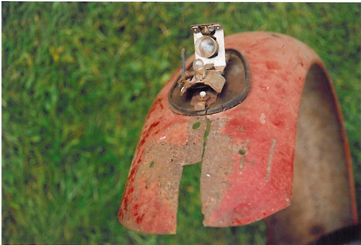
Rostig bakskärm har kapats och svetsats.
