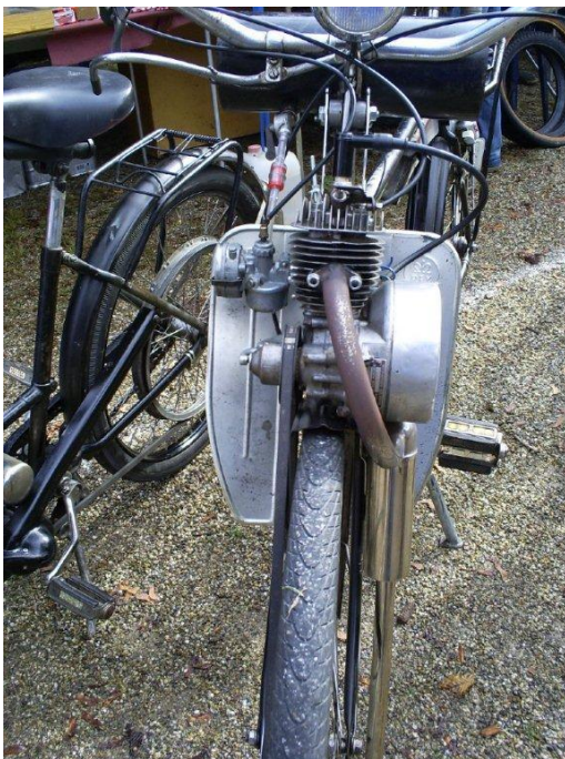
Notera kilrepet för drivningen
